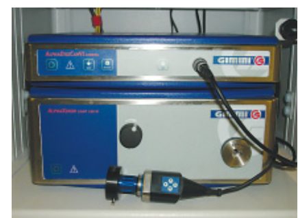
Abb. 3 Xenon-Lichtquelle und Steuereinheit mit Kamerakabel und Kamera.
