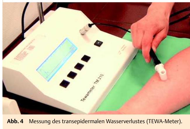
**Abb. 4** Messung des transepidermalen Wasserverlustes (TEWA-Meter).
