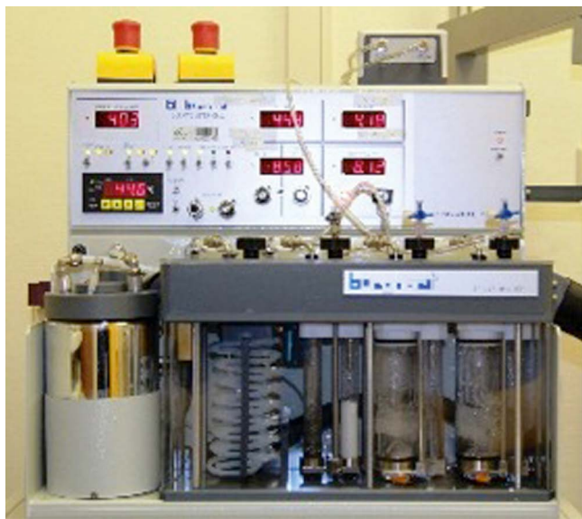
▶ Abb. 1 verwendetes Olfaktometer (OM 2/S Olfaktometer, BURG-HART Messtechnik GmbH, Wedel, Deutschland).
