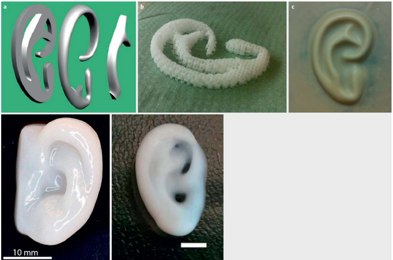
▶ Abb. 4 Mithilfe von Bio-Druckverfahren hergestellte Ohrmuscheln bzw. Teile von Ohrmuscheln aus verschiedenen Materialien. Oben: Abbildung mit Erlaubnis aus [142], unten rechts: Abdruck aus [22]. Copyright 2015 American Chemical Society, unten links: Abdruck aus [23].
