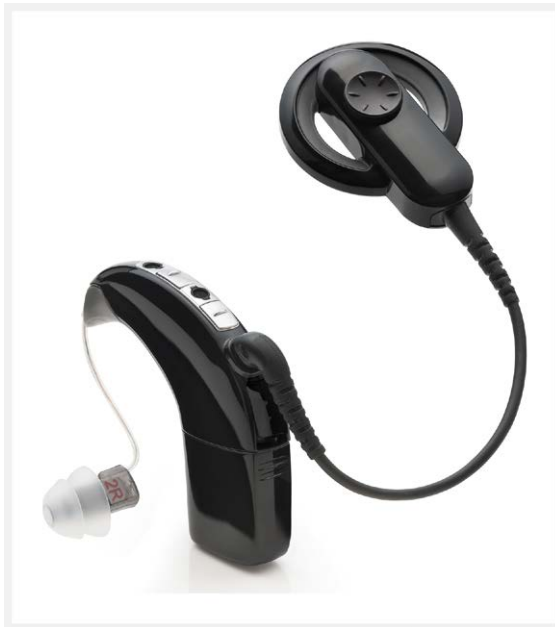
► Abb. 4 Kochleaimplantat mit elektroakustischer Stimulation (Quelle: Cochlear, Deutschland).
