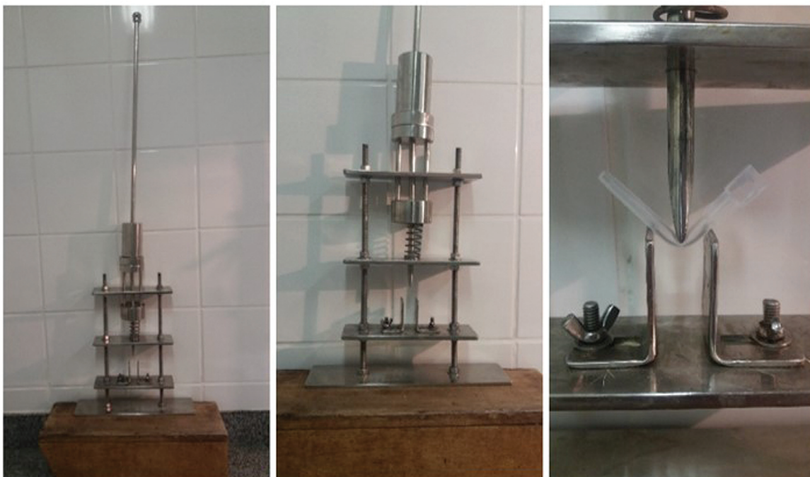
Fig. 2 Guilhotina desenvolvida para fraturas diafisárias do fêmur. À esquerda, toda a estrutura pode ser vista. No centro, um detalhe do peso no final do trilho. À direita, a ponta da guilhotina com simulação da geração de fraturas.
