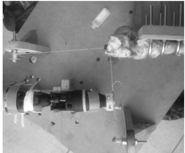
**Fig. 2** Modelo hecho a medida para abrasión cíclica. Se utilizó un motor de ciclado hecho a medida que permitía traccionar la sutura atrás y adelante. El húmero proximal fue fijado con una abrazadera, y se aseguró la perpendicularidad de la sutura al momento del ensayo.
