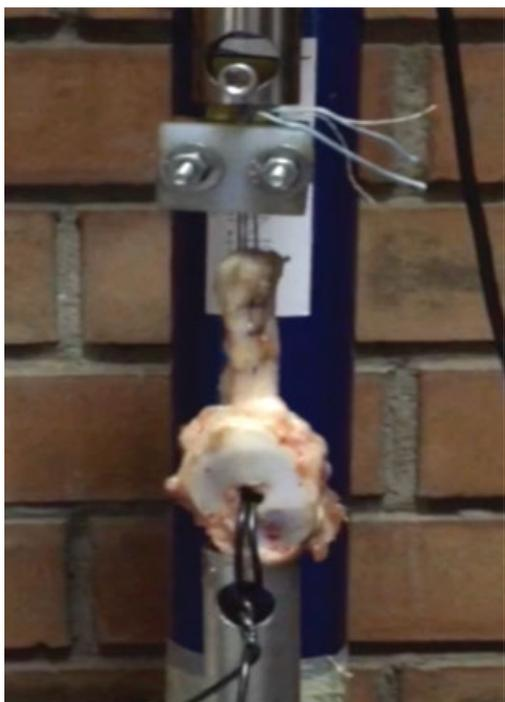
**Fig. 2** Muestra fijada a la máquina de tracción. Las muestras fueron ancladas al soporte móvil de la máquina de tracción a través de un pasador trans-patelar para asegurar la firmeza del constructo. Las suturas del Bunnell fueron ancladas en un soporte fijo.
