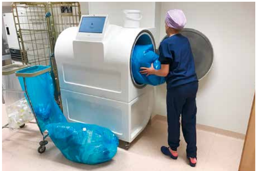
Befüllen des als Drehtrommel ausgeführten RFID-Readers. Foto: CWZ, Nijmegen, Niederlande
