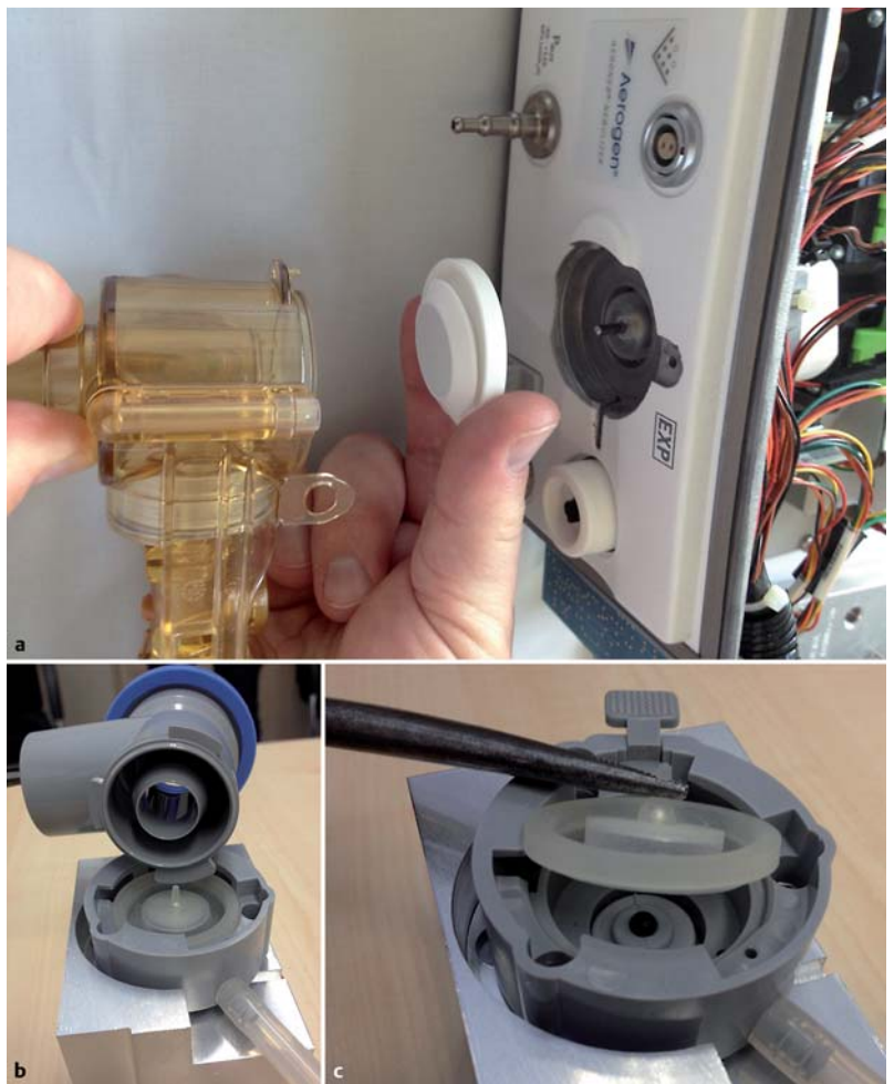
Abb. 11 zeigt Ausatemventile von Beatmungsgeräten. Von der Bauart her handelt es sich dabei um Ventile, die über eine Membran geregelt werden. Bild a zeigt das Ventil des Beatmungsgerätes Engström, Carestation (GE) Bilder b und c das entsprechende Ventil aus der Avea, CareFusion.
