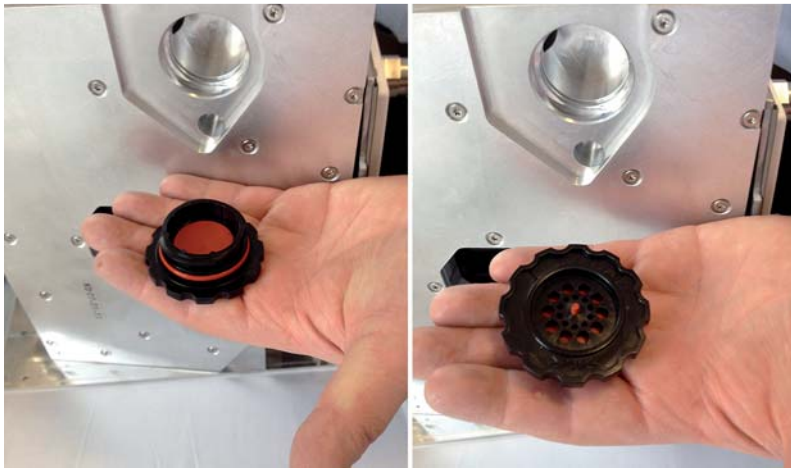
Abb. 12 Die beiden Bilder zeigen das Sicherheitsventil für die Inspiration aus der Engström Carestation (GE). Dieses Ventil ermöglicht ein freies Atmen des Patienten, falls es zu einem Druckabfall im Beatmungsgerät kommt.
