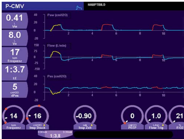
Abb. 8 Die vom Patienten getriggerten Atemzüge werden hier in gelber Farbe dargestellt, die mandatorisch vom Gerät abgegebenen in roter Farbe. Die untere Kurve zeigt den Ösophagusdruck über einen liegenden Ösophaguskatheter an (Pes). Bei der aktiven Einatmung durch den Patienten ist ein Druckabfall zu erkennen. Dagegen ist bei den roten, mandatorisch abgegebenen Atemzügen kein Druckabfall zu erkennen, in diesem Falle entsteht bei diesen Atemzügen eine geringere Atemarbeit bei dem Patienten.
