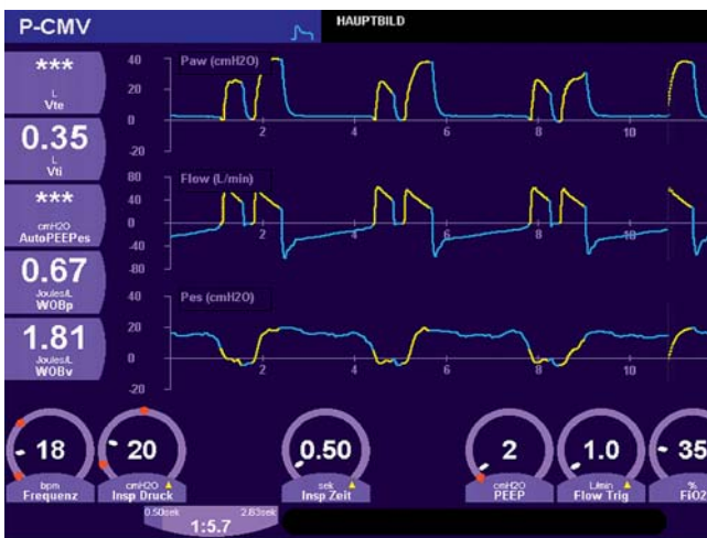
Abb. 12 Doppeltriggerung. Hierbei wird wie durch eine zu kurz gewählte Inspirationszeit die Geräteunterstützung zu früh abgebrochen und innerhalb derselben Atemanstrengung des Patienten ein zweiter Atemzug am Gerät ausgelöst.
