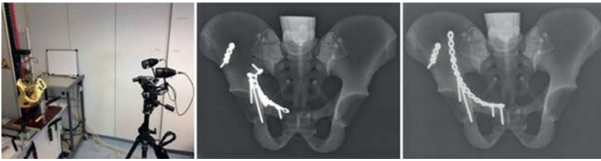
Abb. 4 Versuchsanordnung: Bild links: die Prüfmaschine mit eingespanntem Beckenmodell und optischem Messsystem; Bild in der Mitte: Röntgenbild des Beckenmodells mit angebrachter Flügelplatte; Bild rechts: Röntgenbild des Beckenmodells mit angebrachter J-Platte.
