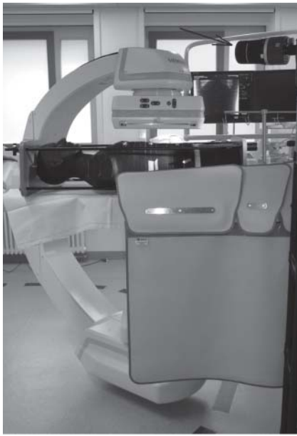
Abb. 1 Messaufbau mit Alderson-Phantom im PA-Strahlengang. Das tischmontierte Strahlenschutzsystem aus Untertisch-Vorhang und Übertisch-Aufsatz (BGW jeweils 0,5 mm) sind im Einsatz. Rechts oben am Bildrand (Pfeil) die Ionisationskammer in Augenposition des Untersuchers bei femoralem Zugang.
