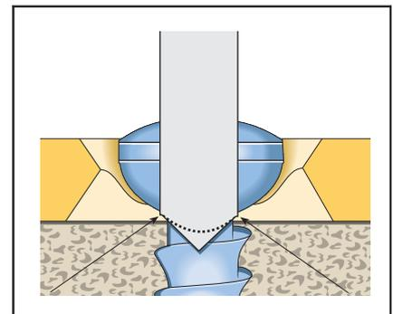
**Abb. 6** Der Kopf muss mit einem Bohrer so aufgebohrt werden, dass der Außendurchmesser dieses Bohrers etwas größer ist als der Kerndurchmesser des Schaftes. Dann schneidet der Bohrer den Kopf zirkulär vom Schaft ab.
