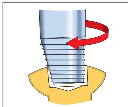
**Abb. 5** Die linksdrehende Extraktionsschraube muss genau den richtigen Durchmesser und Länge haben. Das linksdrehende Gewinde muss sich in den Innendurchmesser des Inbus oder des ausgeleiterten Inbus eindrehen. Auf der anderen Seite muss er kurz genug sein, damit die Spitze nicht auf den „Boden“ aufläuft.
