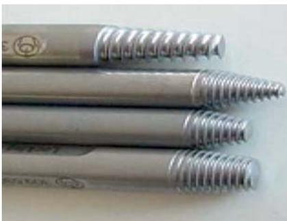
**Abb. 4** Linksschneidende Extraktionsschrauben.
