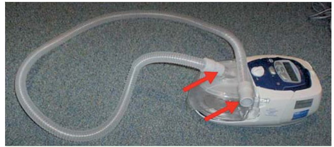
Abb. 1 Messpunkte zur Erfassung von Temperatur und Luftfeuchtigkeit am Befeuchter und am Schlauchende. Die Messung fand ohne Schlauchisolation statt. Temperatur des Raumes 16,4 °C.
