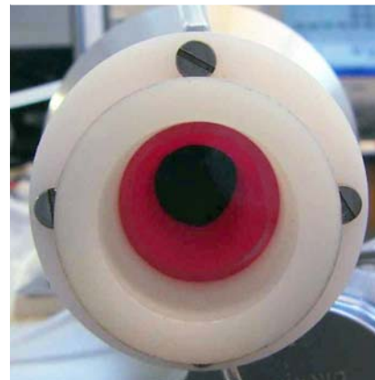
Abb. 6 Pneumatisch gesteuerter Verschlusskörper im geöffneten Zustand.
