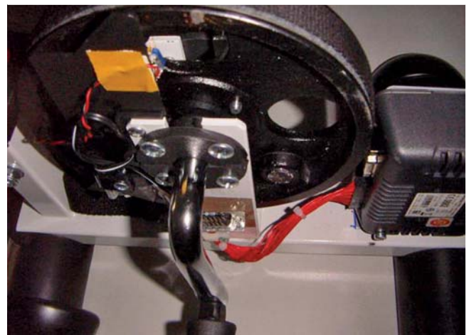
Abb. 1 Bei einer Drehbewegung der Pedale wird durch den Magnetschalter am Schwungrad ein Schaltimpuls ausgelöst, der durch die Auswertelogik in einem Mikro-Controller (GSM-Modul TC-65 Firma Siemens) verarbeitet wird. 15 Sekunden nach Trainingsbeginn werden die Trainingssekunden gezählt. Werden 15 Sekunden lang keine Impulse registriert, erfolgt die Trainingszeit-Berechnung. Die Daten werden per SMS verschickt. Es können bis zu 8 Input-/Output-Kanäle angeschlossen werden.
