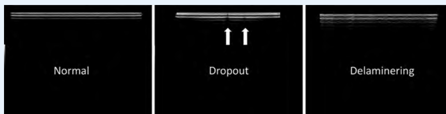
► Fig. 1 Eksempel på normal lineær transducer og derudover transducer med dropout (døde elementer) og transducer som er delamineret.
