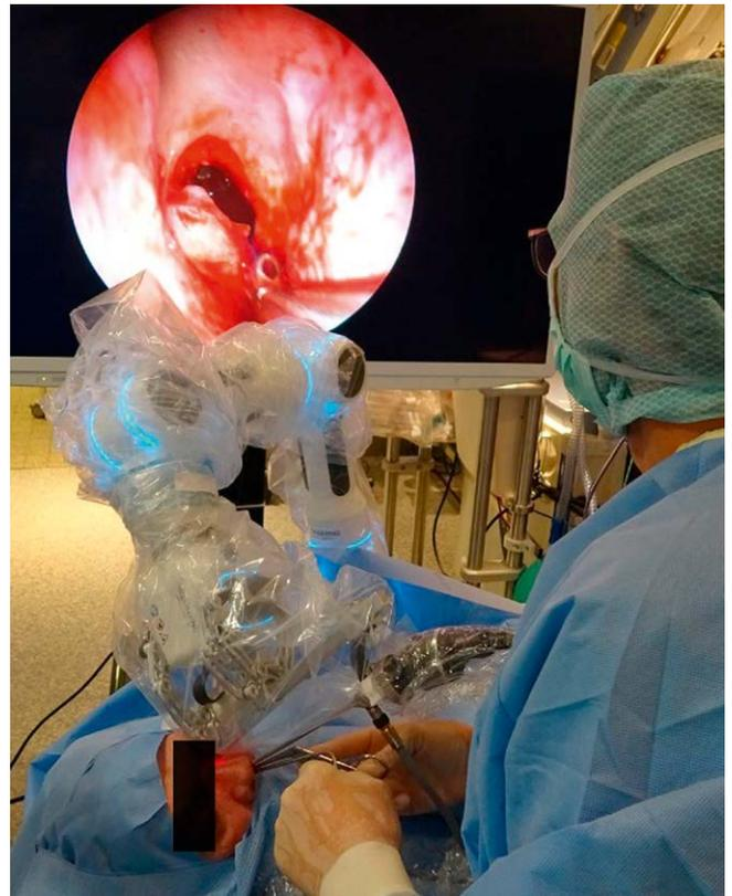
► **Abb. 4** Cirq System (Brainlab AG, München) in der Anwendung als Endoskophalter bei der endoskopischen Nasennebenhöhlenchirurgie. Dem Operateur wird so die beidhändige Instrumentenführung ermöglicht. (Quelle: Eigene Aufnahmen).
